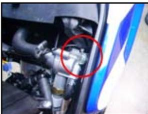
Con l'ausilio dell'occhietto fornito nel kit, agganciare il cavo nero della centralina GPA alla vite evidenziata in foto (punto di massa).
