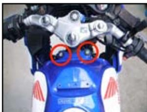
Svitare le due viti di fissaggio serbatoio.
