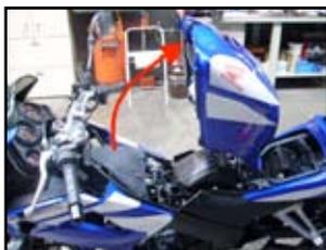
Alzare il serbatoio per poter accedere alla parte motore.
