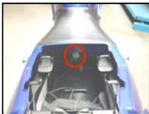
Svitare la vite di fissaggio evidenziata in foto e togliere la sella conducente.
