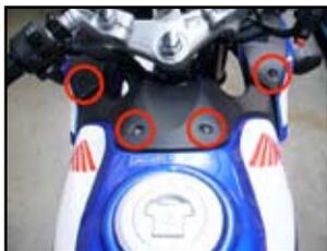
Svitare le viti della parte plastica nera sopra al serbatoio.
